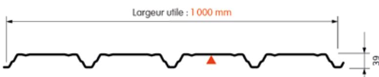
Longueur de profilage : Minimale 1 800 mm / Maximale 15 000 mm
